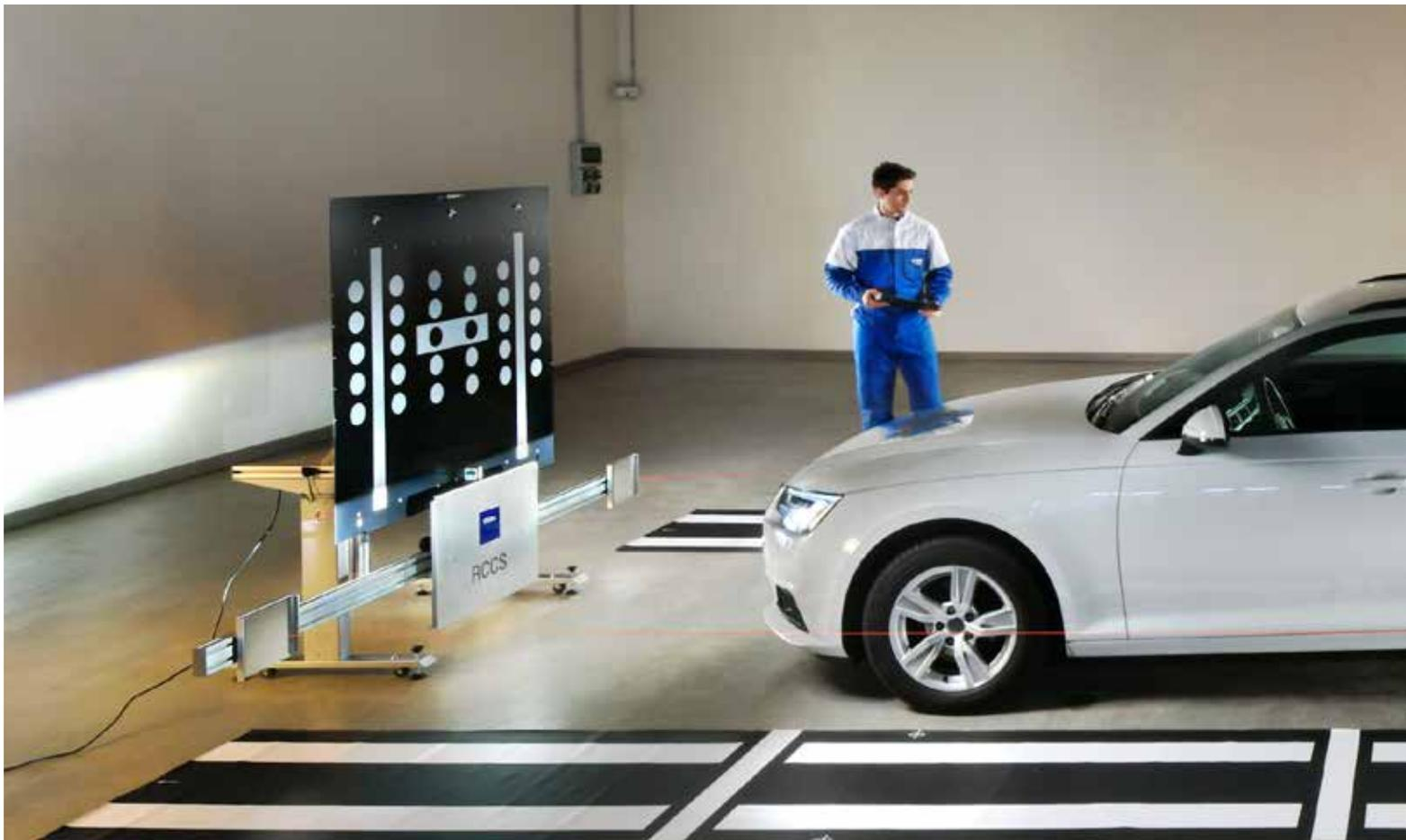
RCCS-System in Verbindung mit seitlichen Kalibrierplatten für 360° Kameras, Kalibriertafel für Heckkameras, Vorrichtung für Totwinkel-Radar.
