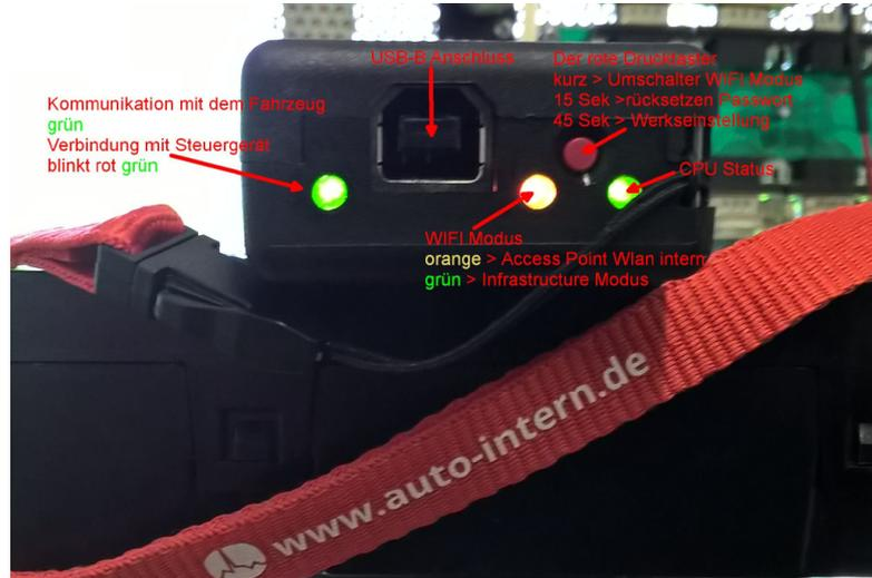
Die Front des HEX-NET Adapters verfügt über 3 LEDs, einen USB-B Anschluss, sowie einen roten Drucktaster.
