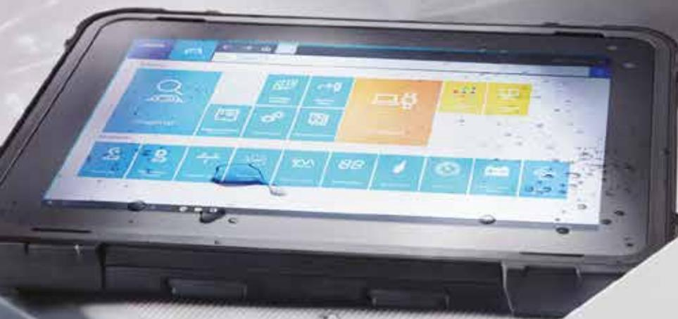
Wasserdicht und schwimmfähig sind Merkmale, die bei der speziellen Version "AXONE Nemo Waterproof" zur Verfügung stehen.
