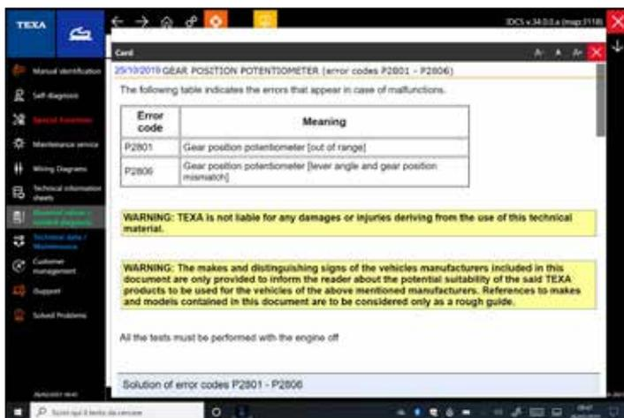
Sehr nützlich, um eine einem **bestimmten Fehlercode zugeordnete Störung** zu beheben, der über die Eigendiagnose festgestellt wurde. Es wird ein Fehlerbaum geliefert, um die Ursache zu beseitigen.
