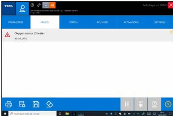
Die Fehlerseite zeigt unverzüglich alle **im Fahrzeug vorhandenen Fehler**, deren Fehlercodes und Beschreibungen. Von hier aus können diese mit einem einzigen Klick **gelesen** und **gelöscht** sowie ein **Eigendiagnosetest** der gewählten Anlage durchgeführt werden.
