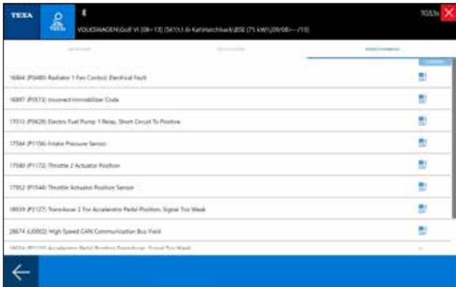
Nach Durchführung der globalen Scannung der an Bord des Fahrzeugs befindlichen Steuergeräte können Sie auf der Registerkarte "Geführte Diagnose" die erkannten Fehler einsehen und durch Klicken auf das entsprechende Symbol die Prozedur zur Fehlerbehebung starten.
