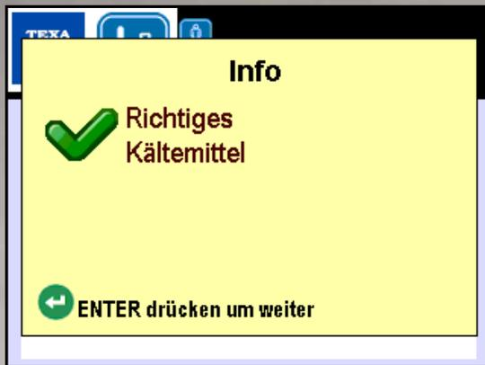
Die Software von TEXA zeigt dem Anwender die Reinheit und Konformität des verwendeten Kältemittels an.
