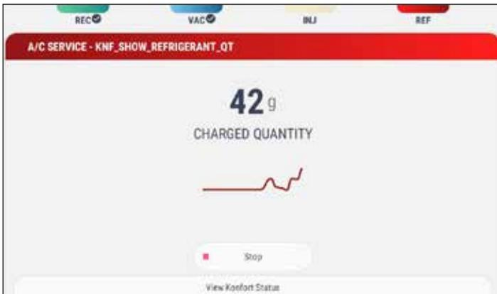
Phase «Befüllung»: Die Station befüllt die Fahrzeugklimaanlage mit der richtigen Menge an Kältemittel.
