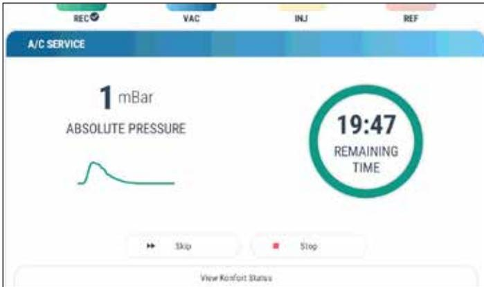
Phase «Vakuum»: In der Fahrzeugklimaanlage wird ein Vakuum erzeugt für die Überprüfung auf eventuelle Lecks.
